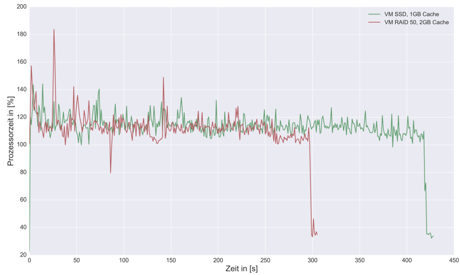
Abbildung B.35.: Direkter Vergleich der Prozessorauslastung, der unterschiedlichen Hardwarekonfigurationen (vm_ssd und vm_hdd) während des Importvorganges von 5.000 Publikationen in der relationalen Datenbank MySQL
