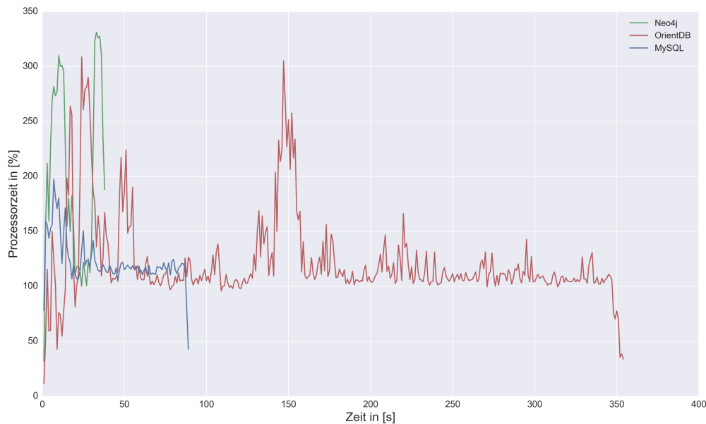
Abbildung 5.5.: CPU Auslastung, während des Importvorganges von 1.000 Publikationen, zur Verarbeitung der Instruktionen der einzelnen Datenbanksysteme
