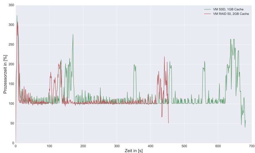
Abbildung B.37.: Direkter Vergleich der Prozessorauslastung, der unterschiedlichen Hardwarekonfigurationen (vm_ssd und vm_hdd) während des Importvorganges von 5.000 Publikationen in der relationalen Datenbank Neo4j
