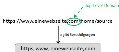
Abbildung 4.4.: Zerlegen einer Webseite in Teilbereiche für die Umsetzung eines Berechtigungskonzepts für Daten in Form einer Graphstruktur
