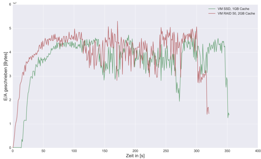
Abbildung B.43.: Direkter Vergleich der Schreibrate, der unterschiedlichen Hardwarekonfigurationen (vm_ssd und vm_hdd) während des Importvorganges von 1.000 Publikationen in OrientDB
