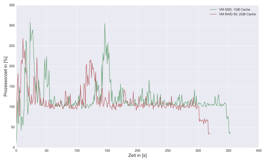
Abbildung B.38.: Direkter Vergleich der Prozessorauslastung, der unterschiedlichen Hardwarekonfigurationen (vm_ssd und vm_hdd) während des Importvorganges von 1.000 Publikationen in der Datenbank OrientDB
