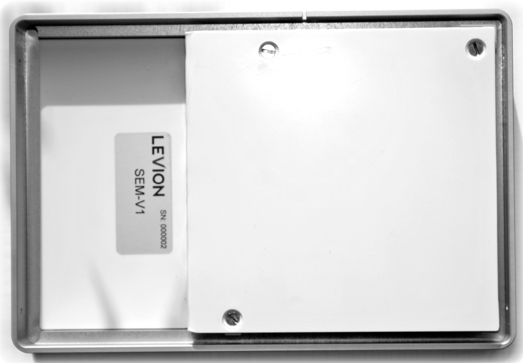
Abb. 60 - SEM: Gehäuse Rückseite mit Kunststoffabdeckung
