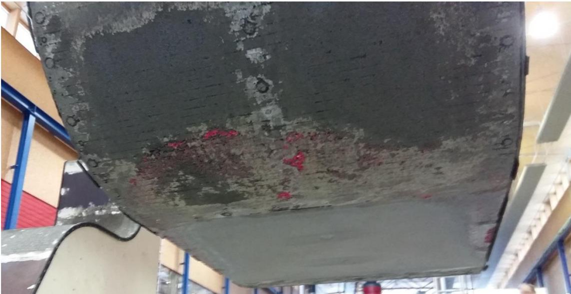
Abbildung 66: Farbindikatorenspuren nach dem Ausschalen
