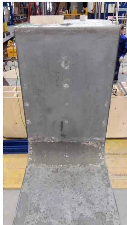
Abbildung 77: Oberfläche Innenwand der Leitplanke (Einfüllseite)
