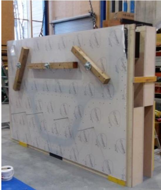
Abbildung 58: Befestigung der Konterschaltung mittels Ankerstäben
