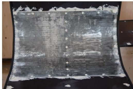
Abbildung 97: Betonoberfläche im Bereich der verzinkten Bleche (Schalung)
