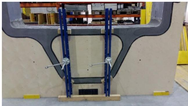
Abbildung 68: Lösen der Innenschalung
