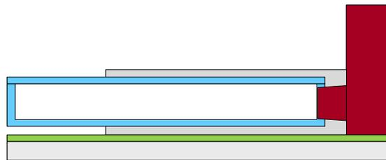
Schritt 2: entfernen der mobilen Stirnschalung
