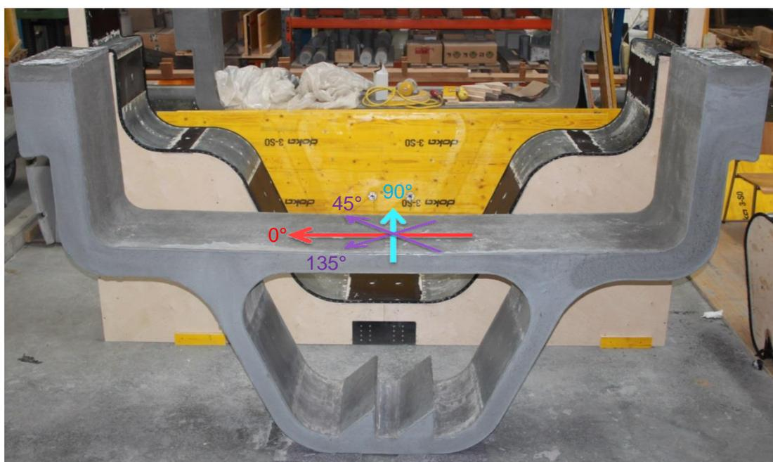
Abbildung 104: gemessene Faserorientierungen am Querschnitt
