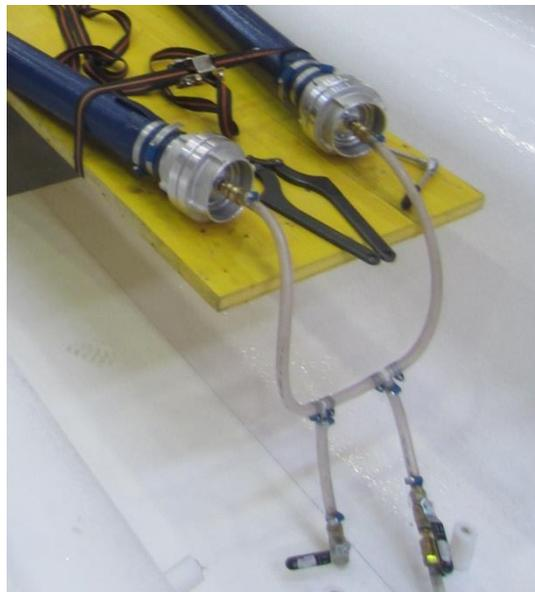
Abbildung 118: Schläuche (Deckel und Ventile)
