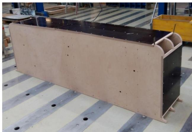
Abbildung 51: Anbringung der Dokaplex- Platten und Bleche (Konterschalung)
