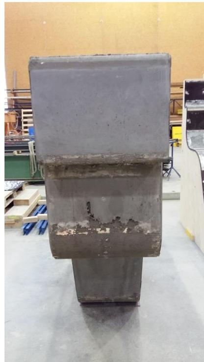
Abbildung 75: Oberfläche Außenseite der Leitplanke (Einfüllseite)
