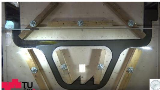
Beide Betonströme treffen sich am linken Fahrbahnrand, (Umlenkconsolen bleiben bis zur Makierung gefüllt)
