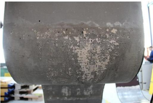
Abbildung 96: Betonoberfläche im Bereich der verzinkten Bleche (Beton)
