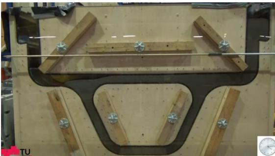
Beide Betonströme treffen sich an der linken Auskragung,
