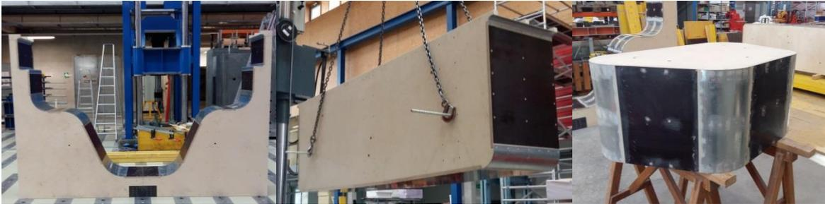
Abbildung 52: Schalungsteile (Außen-, Konter-, Innenschalung)
