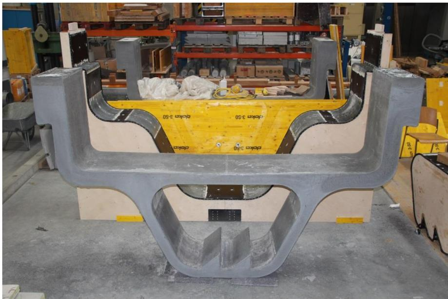
Abbildung 86: Ausgeschalter Träger
