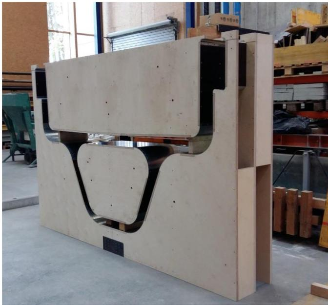
Abbildung 42: Schalungsteile mit Beplankung
