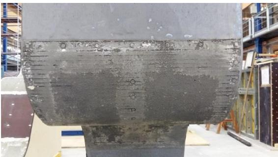
Abbildung 79: Betonoberfläche im Bereich der verzinkten Bleche (Beton)
