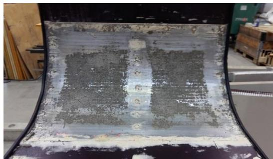
Abbildung 80: Betonoberfläche im Bereich der verzinkten Bleche (Schalung)
