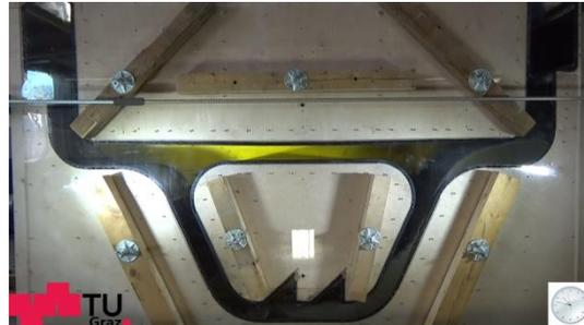
Beton fließt entlang des Hohlkastens,
