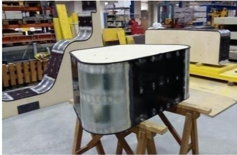
Abbildung 54: Anbringung des Dichtungsprofils an Schalungsteile
