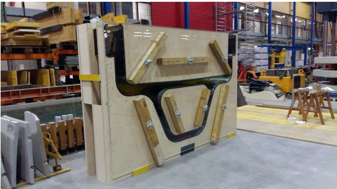
Abbildung 38: Schalung für Befüllversuch
