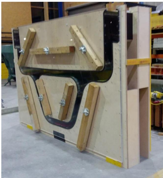
Abbildung 44: Stirnschalung mit Acrylglasplatte
