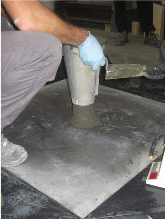
Abbildung 13: Anheben des Trichters
