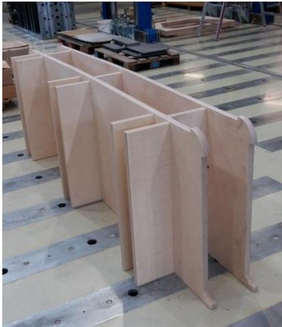
Abbildung 49: Spanten mit Querschotten verschraubt (Konterschalung)
