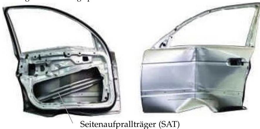
Abbildung 91: Quasistatischer Türeindrücktest nach FMVSS 214
