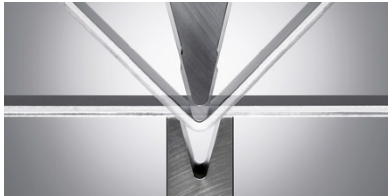
Abbildung 5: Relative Lage der Biegewerkzeuge [EHTa]
