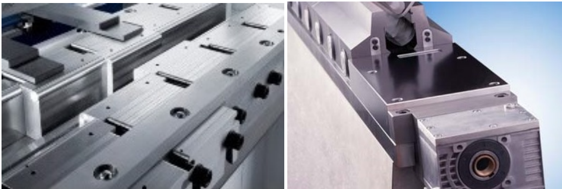
Abbildung 23: Matrizenverstellung durch Spindeltrieb, links [EHTb], rechts [ADR]
