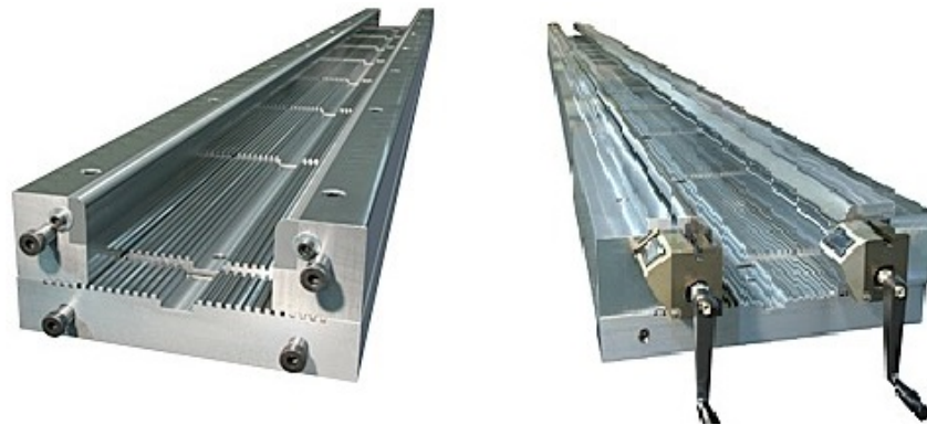
Abbildung 22: Gesenkbackenpositionierung mit Hilfe von Verzahnungen [Acc]
