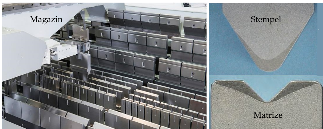
Abbildung 19: Standardwerkzeuge beim Freibiegen
