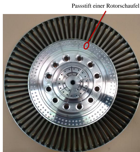
Abbildung 38: Rotor in zusammengebautem Zustand
