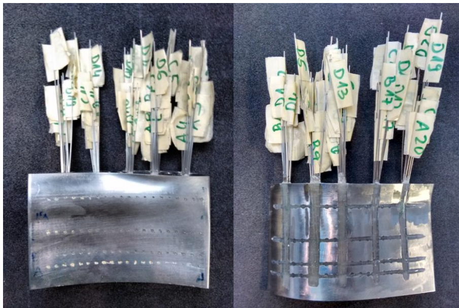
Abbildung 68: EGV instrumentiert – Druckseite
