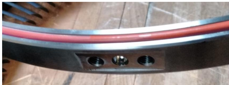
Abbildung 44: O-Ring mit PTFE-Beschichtung
