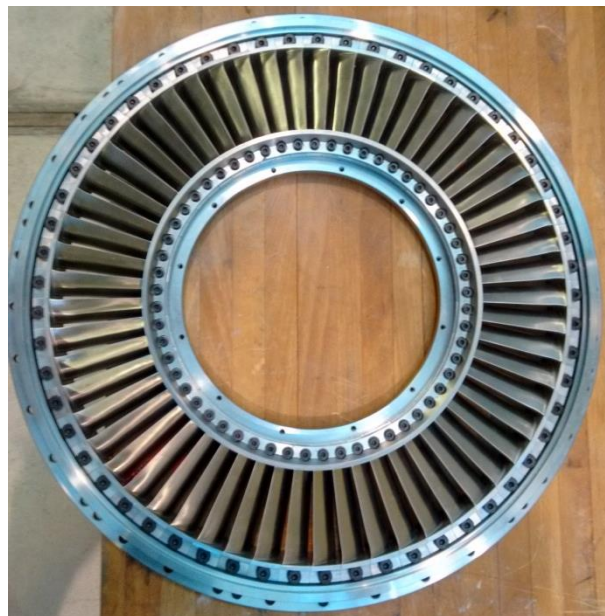
Abbildung 29: Stator in zusammengebautem Zustand (Blick auf die HK)
