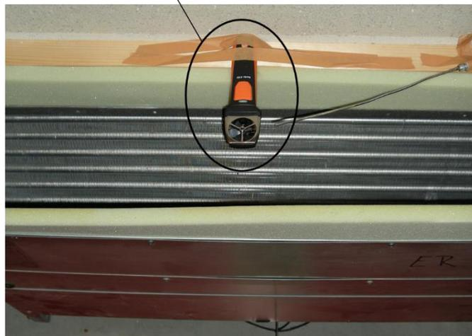
Abbildung 4-15: Messpunkt 1 des Flügelradanemometers am Truheninnengerät ohne Abdeckungen
