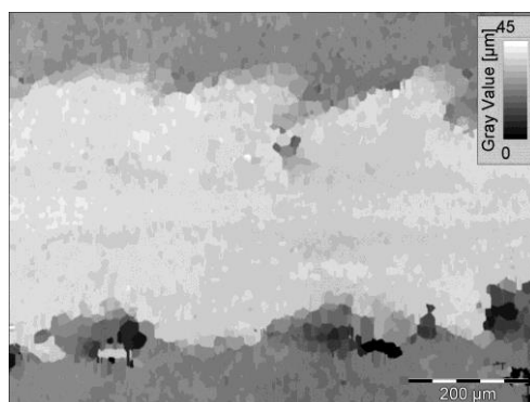
Abbildung 49: Höhenprofil / Mikroskop Olympus BX 61 / Sprödbbruch
