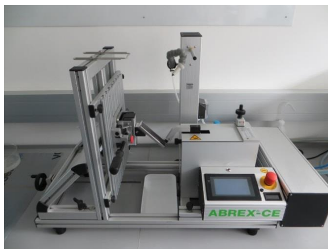
Abbildung 14: Abriebprüfgerät ABREX®-CE im „Scratch – Modus“
