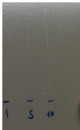
Abbildung 47: Kratzspuren (Prüfbedingungen: 1, 5 und 10N; 20 cm/s)
