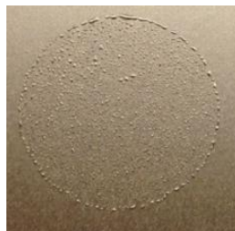
Abbildung 73: Fein verteilte Öltröpfchen auf Lackoberfläche
