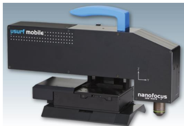
Abbildung 35: Konfokalmikroskop \mu surf mobile [43]
