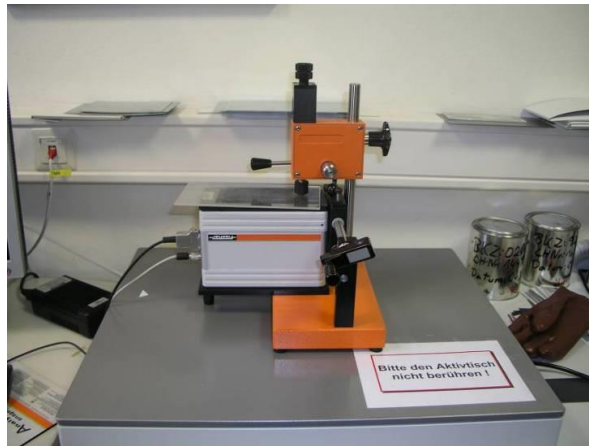
Abbildung 27: Fischerscope H 100-C
