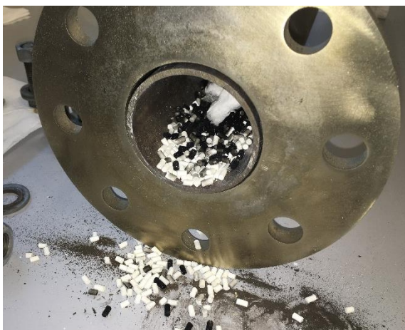
Abbildung 56: Inertmaterial nach der Reformierung Al 2 O 3 (links) und SiO 2 (rechts).
