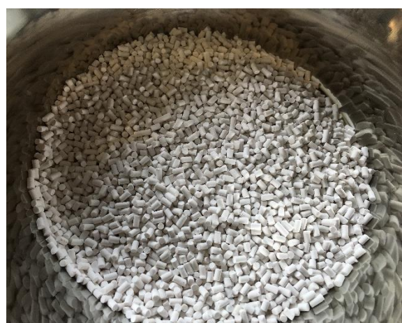
Abbildung 56: Inertmaterial nach der Reformierung Al 2 O 3 (links) und SiO 2 (rechts).
