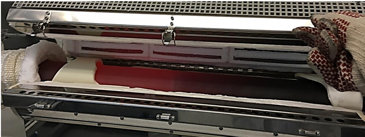
Abbildung 49: Ungleichmäßige Wärmeverteilung am Reaktor bei der Versuchsserie des Katalysators 5 am Ende der Messreihe.
