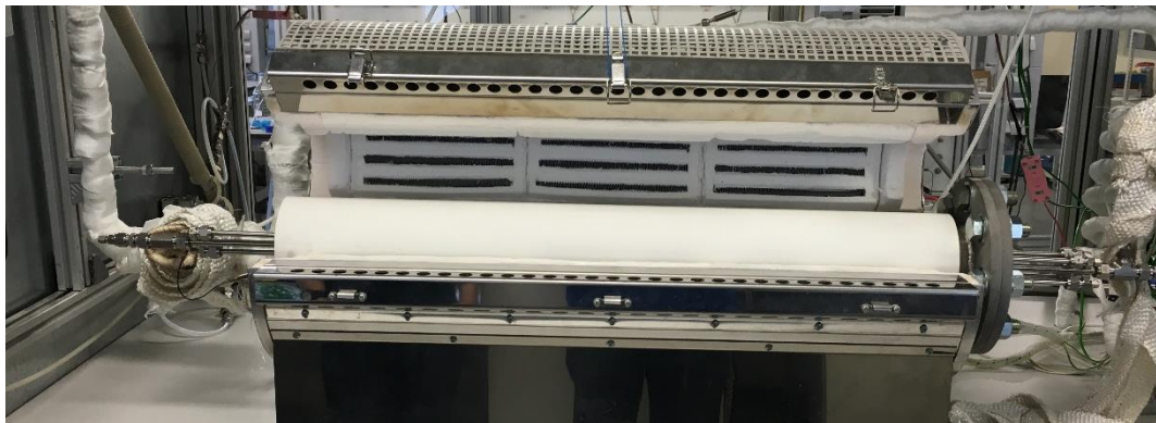
Abbildung 6: Reaktor mit Keramikrohr im Klappofen.
