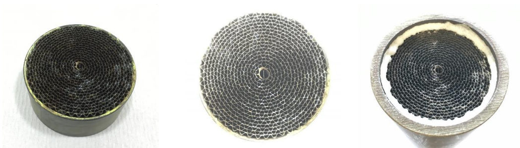
Abbildung 14: Hersteller D Katalysator 6 (links), Oberfläche (Mitte) und in Hülse verbaut (rechts).
