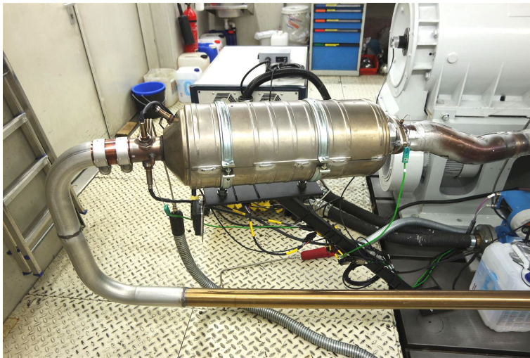
Abbildung 4.4: SCR-Katalysator im Abgasstrang
