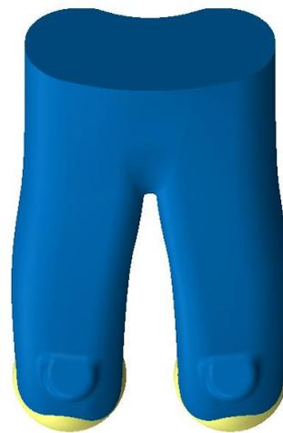
Abbildung 6-25: Konzept II, links: Kanal im Zylinderkopf, rechts: Draufsicht Sandkern
