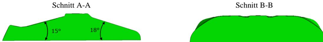
Abbildung 6-57: Schnitte durch den Brennraum
