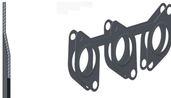
Abbildung 9-30: Links: Form der Sicke, Rechts: Abbildung der gesamten Dichtung
