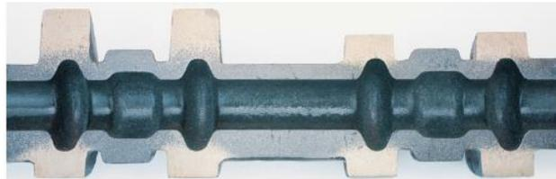
Abbildung 6-67: Schliff einer SHG-Nockenwelle [31]
