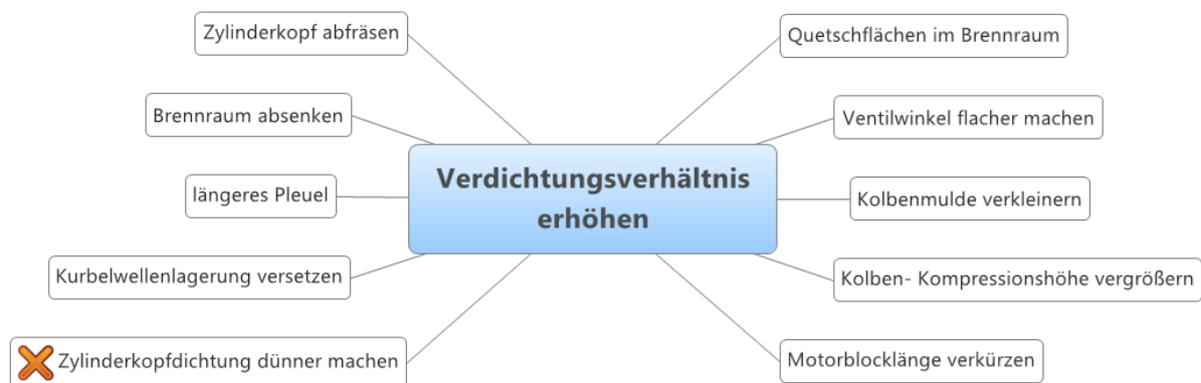
Abbildung 6-60: Brainstorming zu Verdichtungsverhältnis erhöhen
