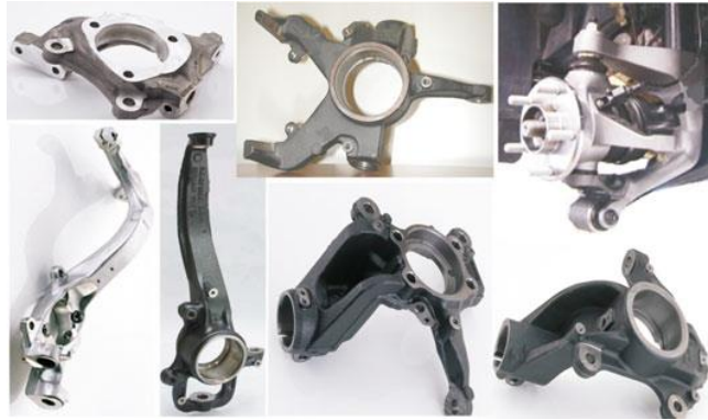
Abbildung 18.: Radträger an angetriebenen VA [16]
