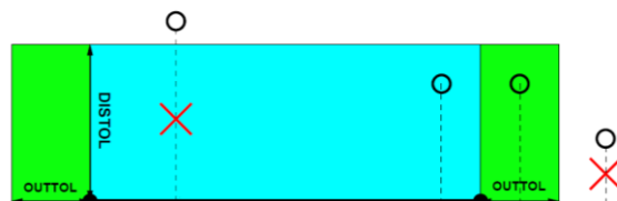
Abbildung 53.: Suchfunktion der Knoten mit DISTOL und OUTTOL [24]
