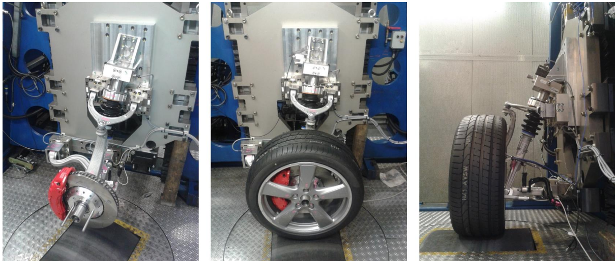
Abbildung 32.: v. l. n. r.: Einzelradaufhängung am Rollenprüfstand ohne Felge und Reifen, Seitenansicht mit Felge und Reifen, Ansicht von hinten mit Felge und Reifen.
