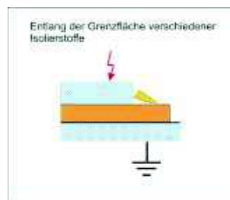
Abbildung 3-15: Gleitentladung in der Grenzschicht verschiedener Isolierstoffe.
