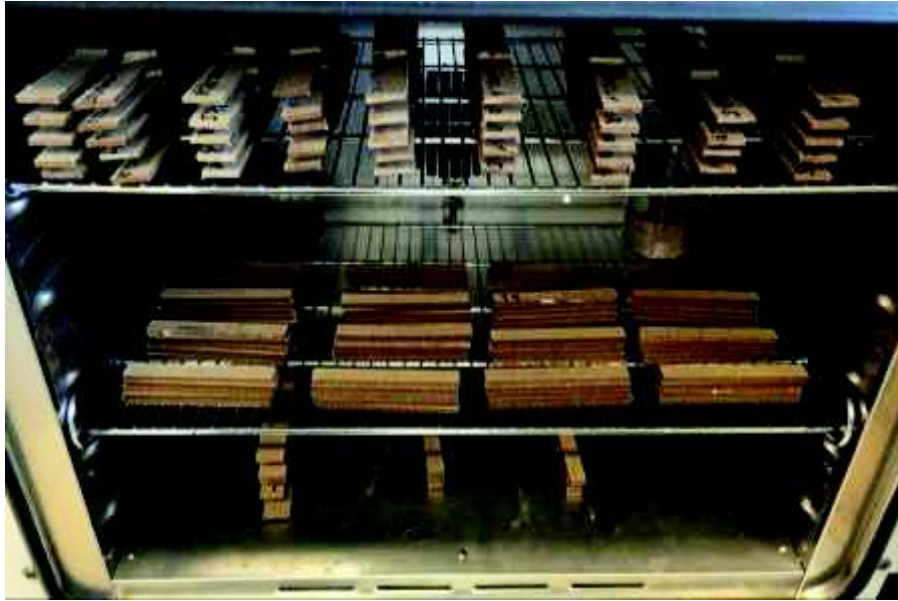
Abbildung 6-4: Vorkonditionierung der Prüfkörper bei 105 °C in einem Umluftofen.
