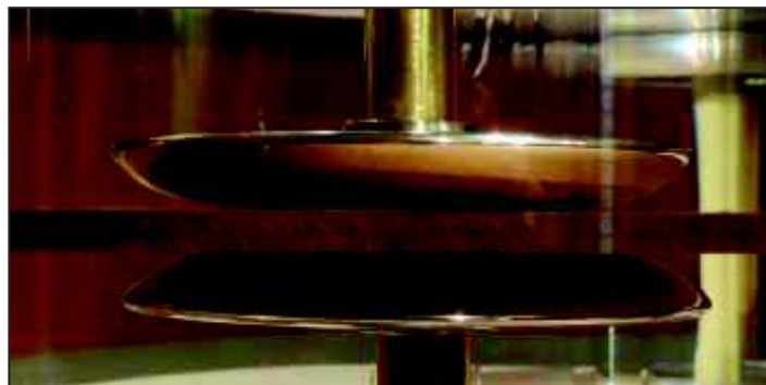
Abbildung 6-2: Transformerboards mit Einfachverklebung zwischen den Elektroden für die TE-Messung.
