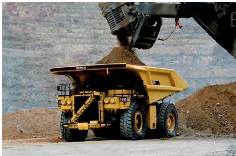
Abbildung 2.11: unbemannter Muldenkipper von Caterpillar [10]
