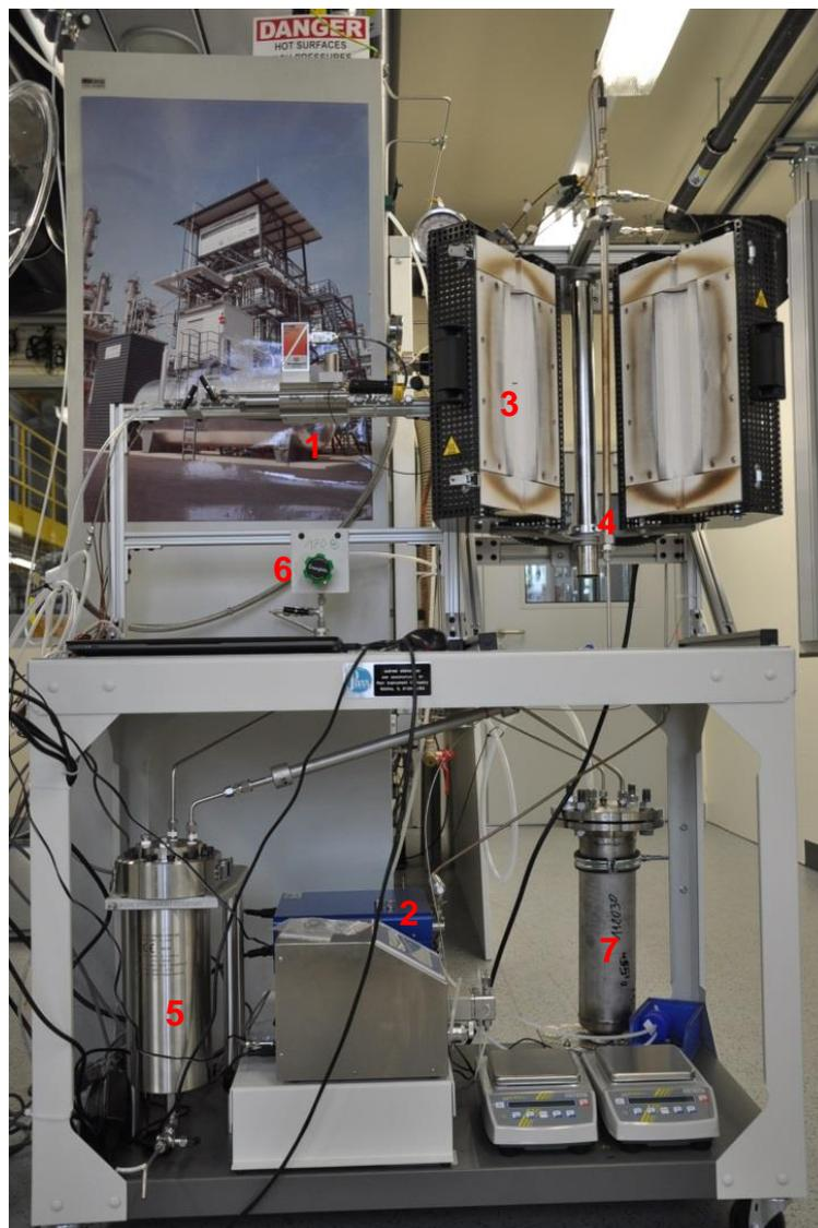
Abbildung 10: Aufbau der Versuchsanlage mit Benennung der wichtigsten Komponenten: Massflowcontroller (1), Hochdruckpumpe (2), Heizmantel (3), Rohrreaktor (4), Produktbehälter (5), Druckregelungsventil (6) und Expansionsbehälter (7);
