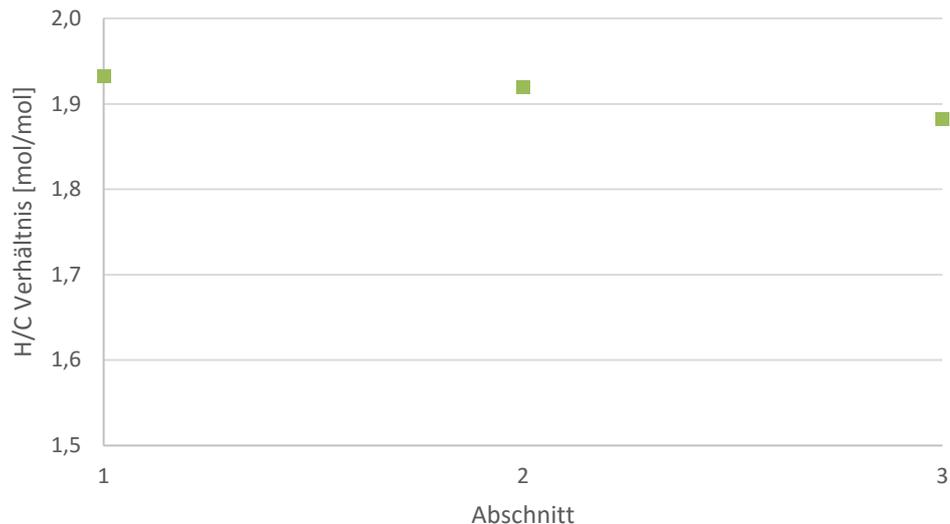
Abbildung 20: H/C-Verhältnis und Produktausbeute des Versuchs VZV1 über die gesamte Versuchsdauer
