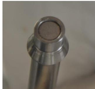
Abbildung 14: Lochplatte zum Verschließen des Reaktorrohrs; links im ausgebauten Zustand, rechts montiert
