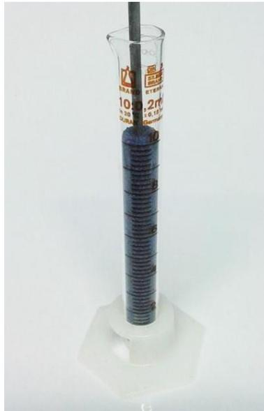
Abbildung 16: Versuchsaufbau zur Bestimmung der Schüttdichte des Katalysators.
