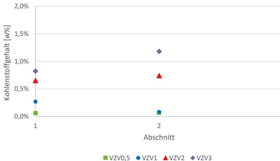
Abbildung 55: Kohlenstoffgehalt der wässrigen Phase in Abhängigkeit der Verweilzeit und der Versuchsdauer
