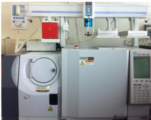
Abbildung 7: Aufbau des verwendeten GCMS
