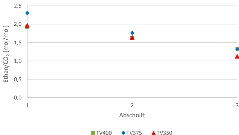
Abbildung 44: Verhältnis des Ethan/ $\text{CO}_2$ -Gehaltes des Abgases in Abhängigkeit der HDO-Temperatur und der Versuchzeit
