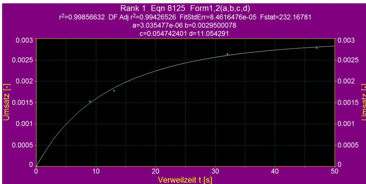
Abbildung 66: Fit der Umsatz/Verweilzeit-Daten mit dem Programm Table Curve; Gezeigt wird eine Überlagerung der Reaktionsordnungen  $n=1$  und  $n=2$
