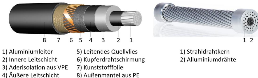
Abbildung 2.2: VPE-Kabelaufbau (l) [10] – Aufbau eines Freileitungsseils (r) [11]
