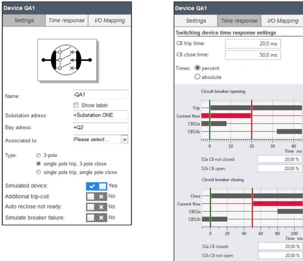
Abbildung 6.14: Mögliche Einstellungen von Schaltgeräten - Umspannwerk-Simulator: OMICRON electronics
