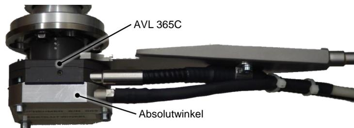
(a) AVL 365C mit magnetischem Drehgeber
