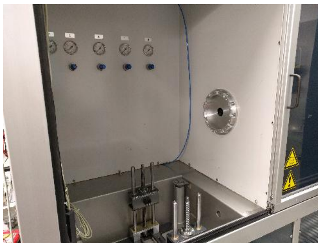
Abbildung 7.3.: Platzbedarf des Flansches in der Prü fzelle
