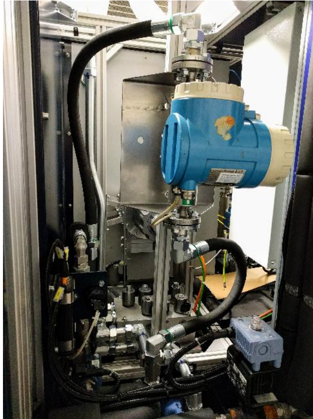
Abbildung 7.6.: Pumpenprüfstand eingebaut und verrohrt von hinten
