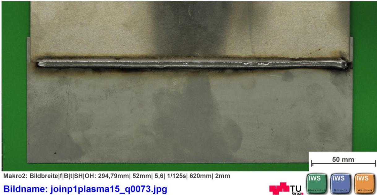
Abbildung 7-5: Schweißnahtaussehen des dritten Versuchs der ersten Referenzversuchsreihe mit einer Geschwindigkeit von 105 cm/min
