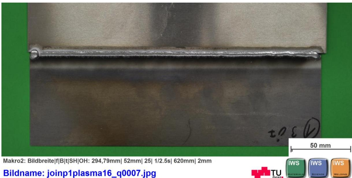
Abbildung 7-6: Schweißnahtaussehen des ersten Versuchs der zweiten Hauptversuchsreihe mit einer Geschwindigkeit von 105 cm/min
