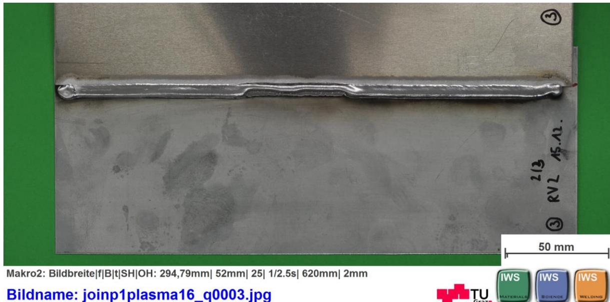
Abbildung 4-3: Ungenauere Offseteinstellung beim dritten Versuch der zweiten Referenzversuchsreihe
