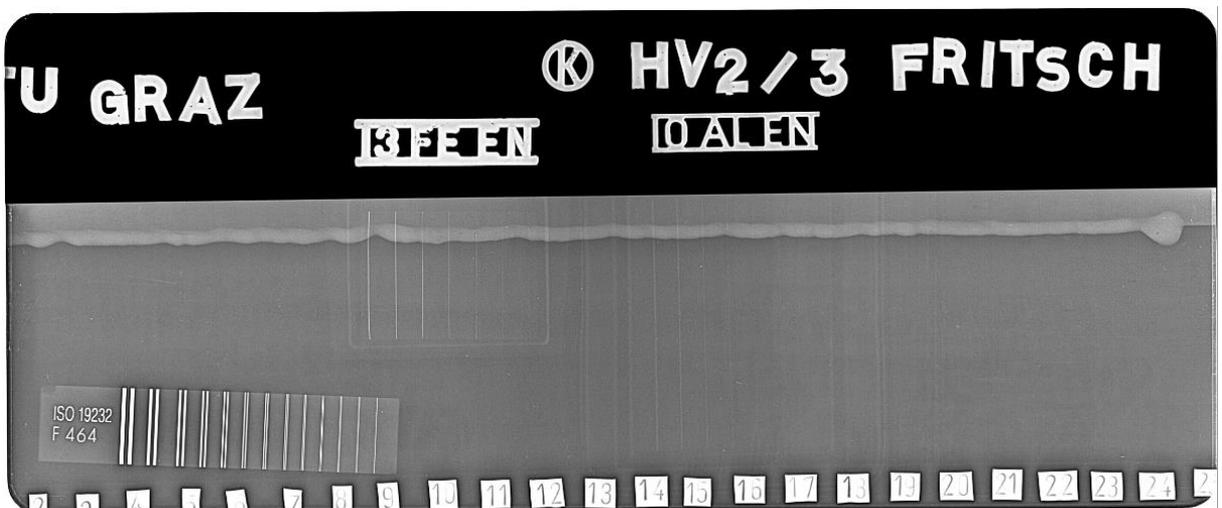
Abbildung 7-9: Digitales Röntgenbild des dritten Schweißversuchs des HV2
