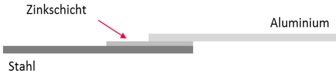
Abbildung 2-1: Verwendete Werkstoffe und deren Anordnung vor dem Schweißprozess
