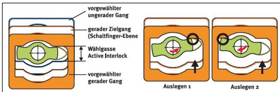
Abbildung 3.25 Funktion Schaltfingereinheit (Wagner et al., 2006, S. 144)
