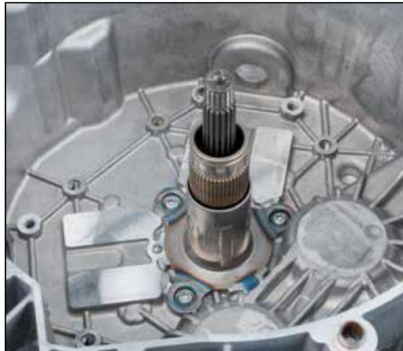
Abbildung 5.5 Bearbeitung Getriebeglocke LuK Hebelaktuator (vgl. Schaeffler Automotive Aftermarket GmbH & Co. KG, 2014, S. 22)
