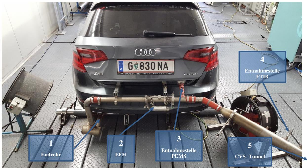
Abbildung 5-7: Abgasentnahme beim Audi A3 e-tron
