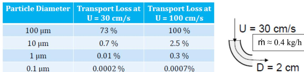
Abbildung 5-19: Gravitationsverluste in einem gebogenen Rohr[47]
