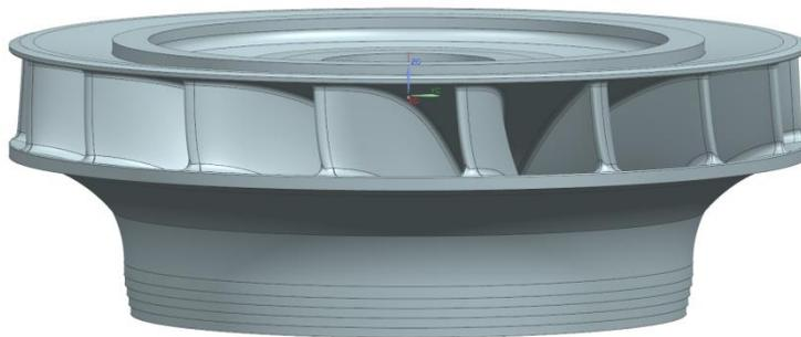
Abbildung 33: CAD-Geometrie des Laufrades
