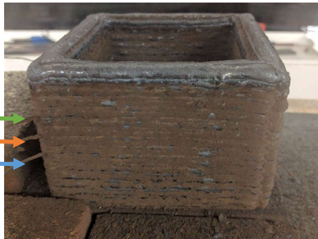
Abbildung 16: Lage der Thermoelemente bei Schweißgut
