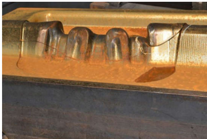
Abbildung 45 gebrochenes Schmiedewerkzeug (Böhler W302)
