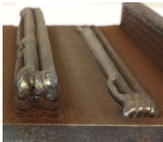
Abbildung 29: Unvollständige Benetzung zwischen den Spuren bei Schweißungen mit Parametersatz A.
