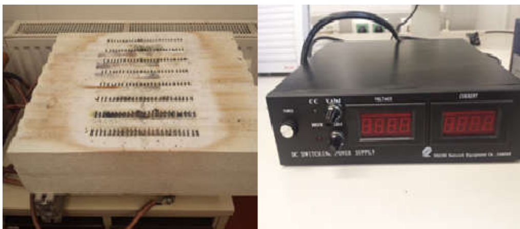
Abbildung 17: Heizplatte und Gleichspannungsnetzteil
