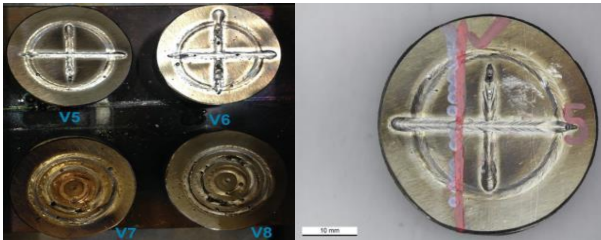
Abbildung 33 links: Übersicht der elektronenstrahlgeschweißten Proben (horizontale Anordnung) V5 bis V8; rechts: makroskopische Aufnahme der Draufsicht und Markierung der Schneidelinie, Probe V5
