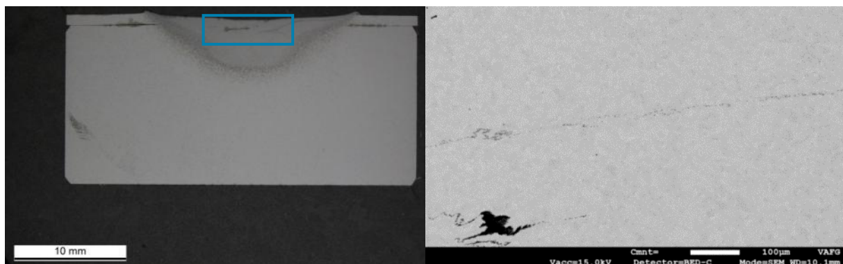
Abbildung 47 links: makroskopische Aufnahme des Querschliffes; rechts: REM-Aufnahme der Verteilung der NME in Form der Linien, Probe FSW3
