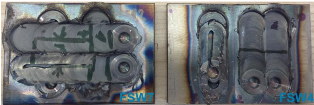
Abbildung 49 Übersicht der rührreibgeschweißten Proben FSW4 und FSW7
