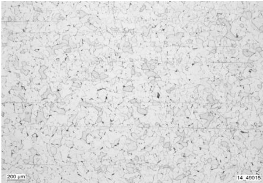
Abbildung 56 LiMi-Aufnahme der Einschlusslinien, Probe S3, geätzt mit Nital 3 %ig
