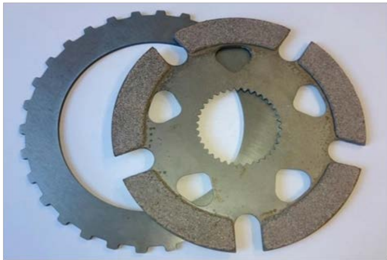
Abbildung 2-11: Darstellung der verwendeten Lamellenpaarung im Verteilergetriebe
