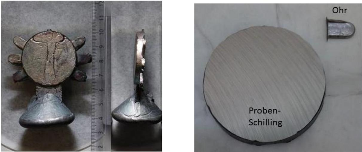
Abbildung 19: Schillingprobe (links: Zustand nach dem Gießen, rechts: Zustand vor der chemischen Analyse).
