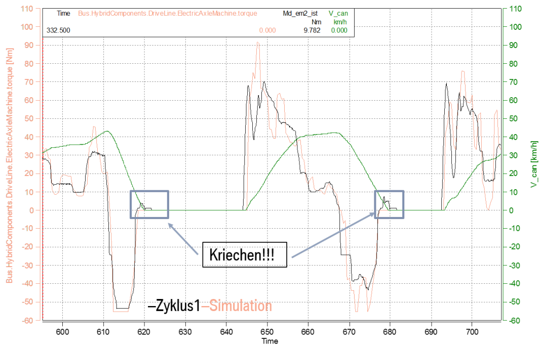
Abbildung 3.19: Moment an der E-Maschine des PHEV(P4) aus Messung am Rollenprüfstand in einem FTP72 Fahrzyklus
