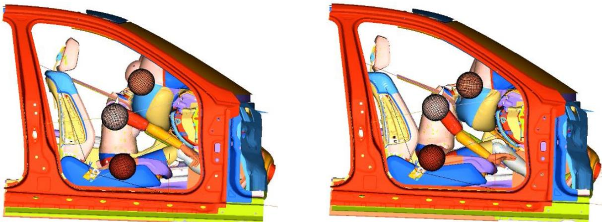
Abbildung 63: Überlagerung bei  $t_0 + 80\text{ms}$  und bei  $t_0 + 120\text{ms}$
