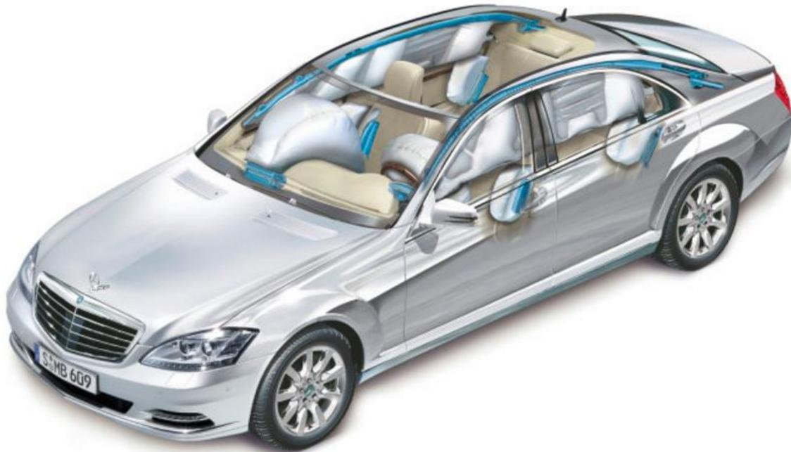
Abbildung 1: Rückhaltesystemkomponenten [8]
