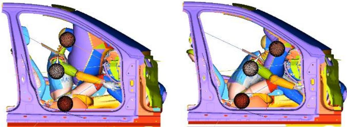
Abbildung 52: Überlagerung Ersatz- & FE Modell bei  $t_0+100ms$  und bei  $t_0 + 150ms$
