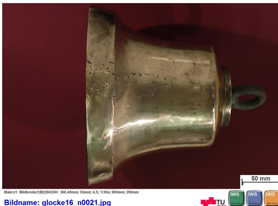
Abbildung 58: makroskopische Untersuchung der Glockenoberfläche nach der WIG-Schweißung mit 50%He / 50%Ar - unerwartet starke Porenbildung
