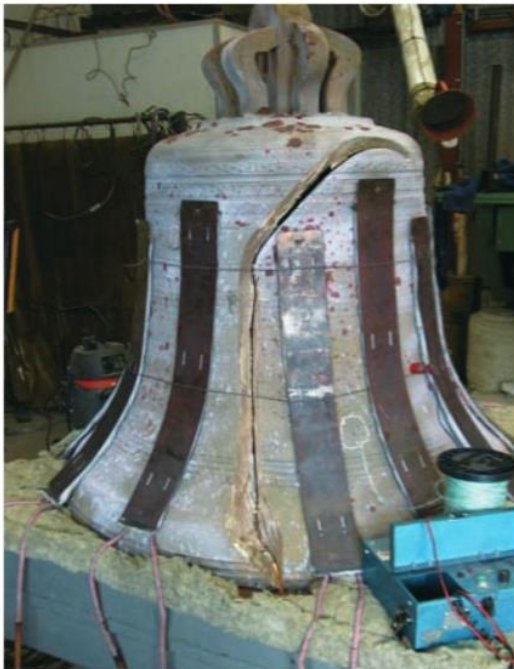
Abbildung 4: Vorwärmung bei Glockenreparatur; links : elektrische Heizelemente an Glockenwand rechts : thermisch isolierende Decken [11]
