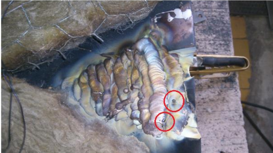
Abbildung 34: Schweißlagenaufbau – Schweißversuch 2 an Glocke, rot markierte Bereiche zeigen Schlackenbildung, gut erkennbar die gelblich-weiße Schmauchschrift neben bzw. an den Schweißraupen
