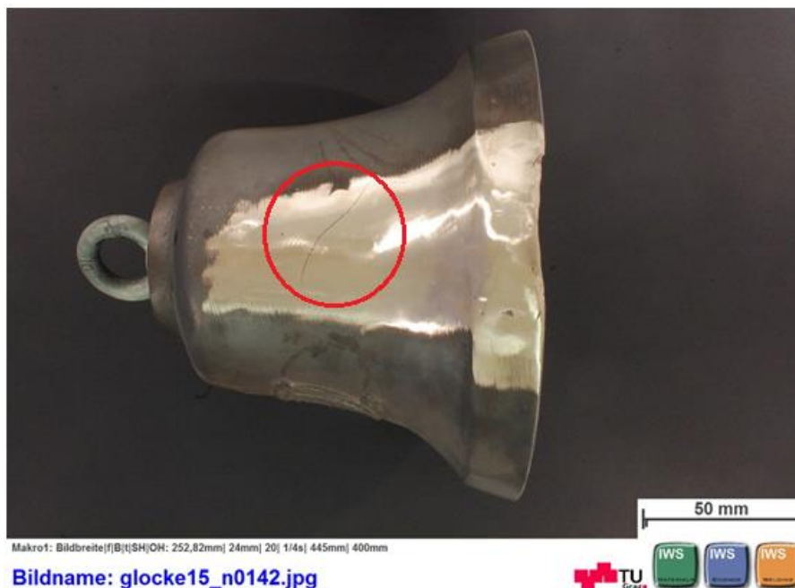
Abbildung 55: makroskopische Untersuchung der Glockenoberfläche nach der WIG-Schweißung mit 100%He / Rissbildung (roter Kreis) durch zu geringe Vorwärmtemperatur
