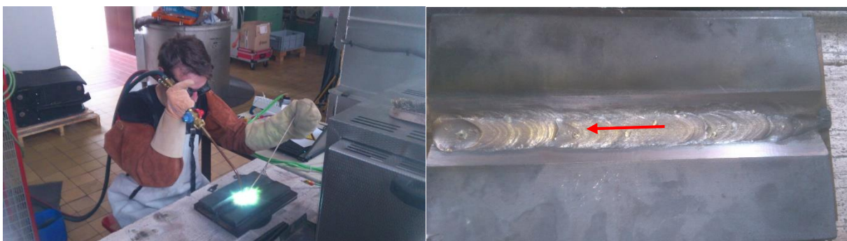
Abbildung 28: links : Dipl.Ing. Markus Stütz beim autogenen Schweißen, rechts : Probeplatte mit breiten Schweißraupen und Zunderung a.d. Oberfläche auf Grund der Vorwärmung, Pfeil markiert die Schweißrichtung
