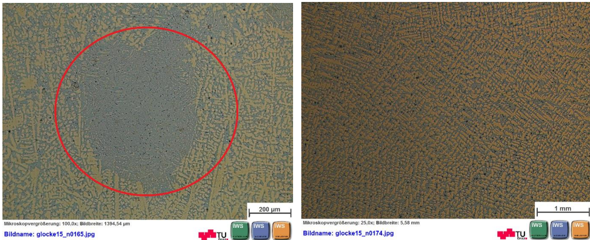
Abbildung 62: Mikrostruktur der WIG-100%He-Schweißung nach OPS-Politur links : Detailaufnahme Schweißgut SG mit Verarmung an alpha-Mischkristallen, rechts : GW
