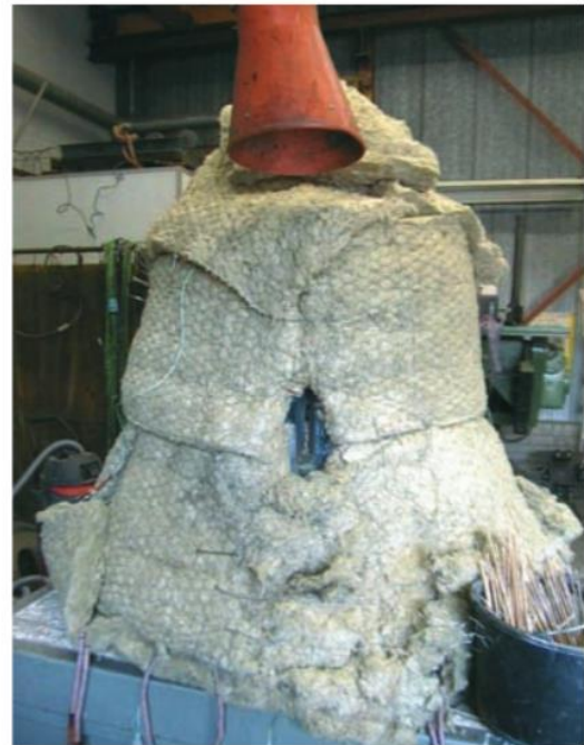
Abbildung 4: Vorwärmung bei Glockenreparatur; links : elektrische Heizelemente an Glockenwand rechts : thermisch isolierende Decken [11]
