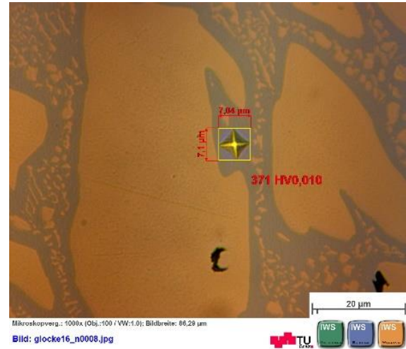
Abbildung 68: links : Mikrohärtemessung der \alpha -Phase, rechts : Mikrohärtemessung der \delta -Phase
