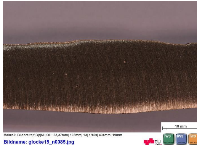
Abbildung 53: Geringfügiger Porenanteil im Querschnitt des Schweißgutes bei 100% He
