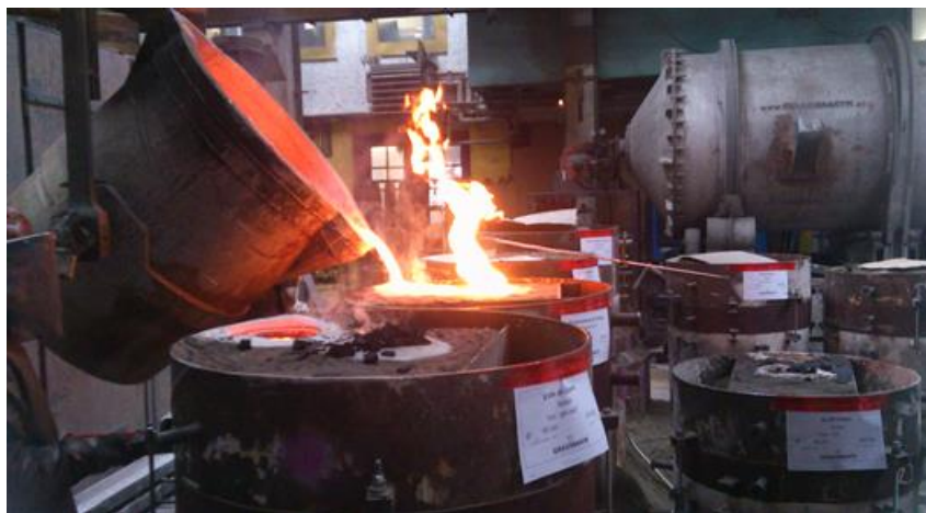
Abbildung 1: Glockenguss bei der Firma Grassmayr im August 2015, vorne : Formkasten mit Holzkohle am Steiger, hinten : Vergießen der Glockenbronze wobei brennende Gase aus dem Steiger entweichen
