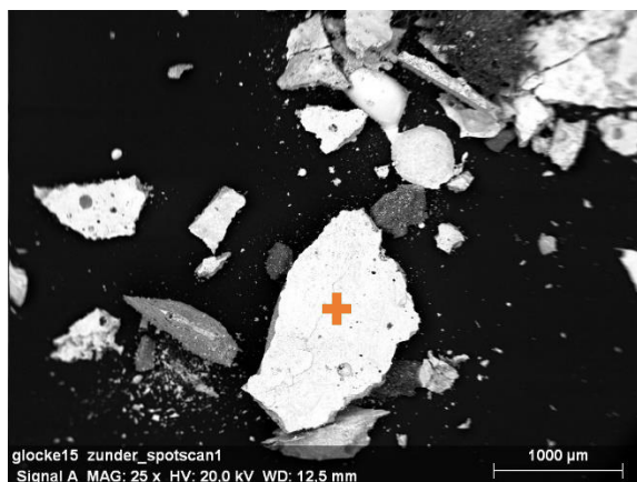
Abbildung 47: Bild der abgeplatzen Zunderschicht aus Schweißversuch 4.3 mit dem zugehörigen EDX-Spotscan, das orange Kreuz markiert dabei die analysierte Stelle
