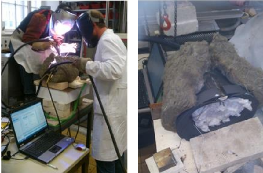
Abbildung 43: links : Schweißung der Glocke; rechts : thermisch isolierte Glocke, dunkle Verfärbung der Oberfläche aufgrund der Zunderung
