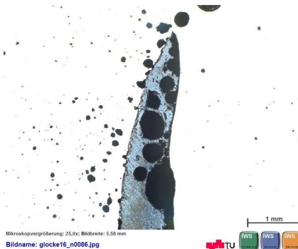
Abbildung 66: überbelichtete Detailaufnahme des Bindefehlers mit darunterliegenden Poren
