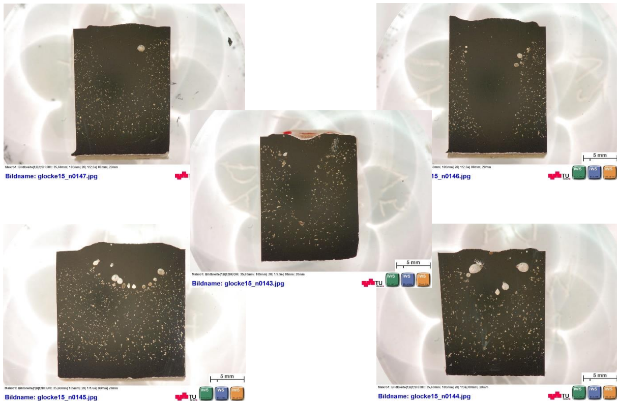
Abbildung 52: makroskopische Untersuchung der Schmelzzonen nach der EBW-Schweißung
