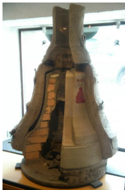
Abbildung 2: Aufbau der Gussform nach dem traditionellen Lehmformverfahren
