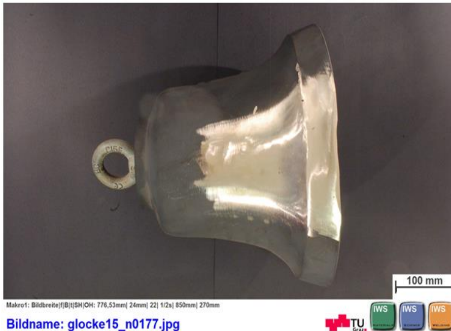
Abbildung 56: makroskopische Untersuchung der Glockenoberfläche nach der WIG-Schweißung mit 100%He / ohne Riss
