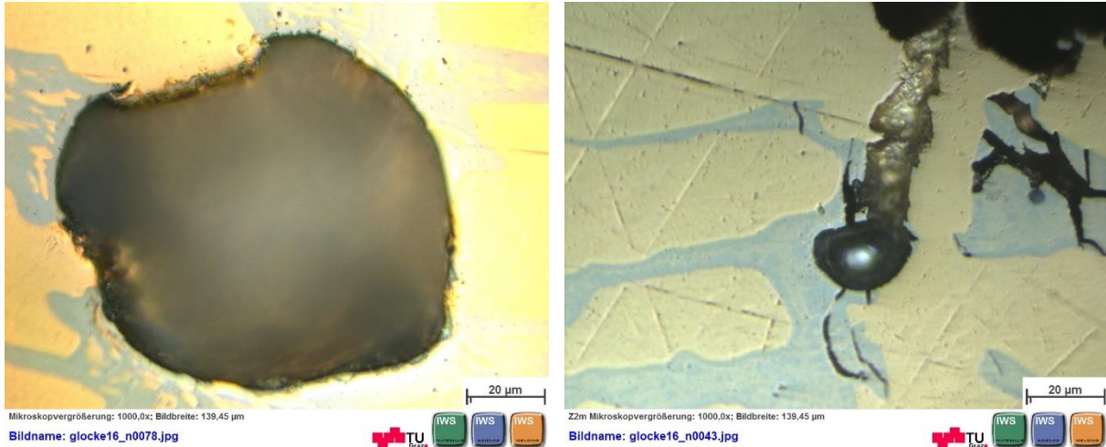
Abbildung 44: links : Blei-Verunreinigungen in Glockenbronze, Aufnahmen am Lichtmikroskop Zeiss Z1m Observer; rechts : Pb-Ausdampfung im festen Zustand im Zugversuch bei 350 °C [37]
