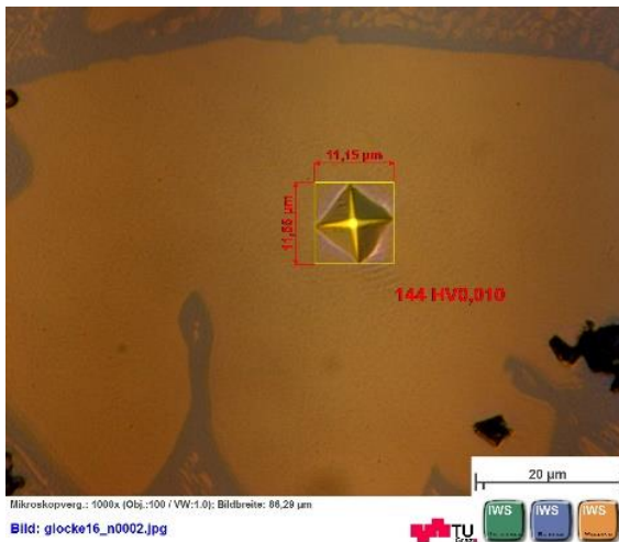
Abbildung 68: links : Mikrohärtemessung der \alpha -Phase, rechts : Mikrohärtemessung der \delta -Phase
