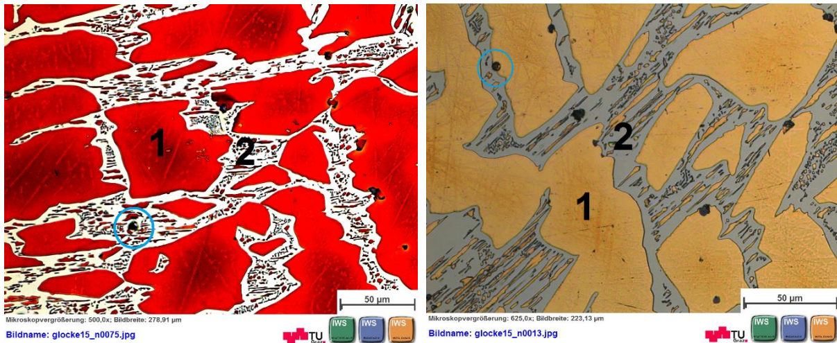
Abbildung 59: links: Farbätzung von Grundwerkstoff nach Klemm III, rechts: Grundwerkstoff nach OPS-Politur, Bereiche 1..dendritische \alpha -Phase, Bereiche 2.. \alpha+\delta -Eutektoid, blaue Kreise markieren Pb-Einschlüsse
