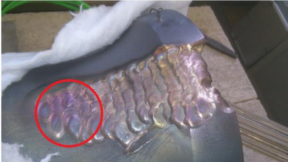
Abbildung 32: geschweißte Glocke in Wannenlage, die einzelnen Schweißlagen verlaufen quer zur Fuge, bei der Steigung in Richtung Schlagring ist ein Abfließen der Schmelze erkennbar, rot markierter Bereich zeigt Riss welcher während der Schweißung entstand
