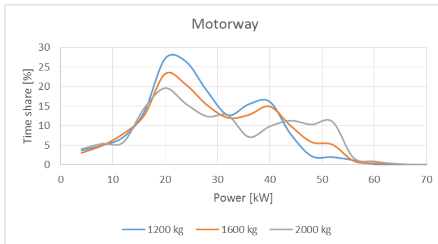
Abbildung 3-32: Einfluss der Fahrzeugmasse auf die Leistungsverteilung, Autobahnzyklus
