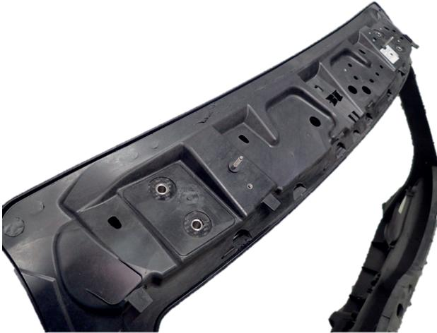
Abbildung 7.3: Schweißnaht am HKL Deckel oben.
