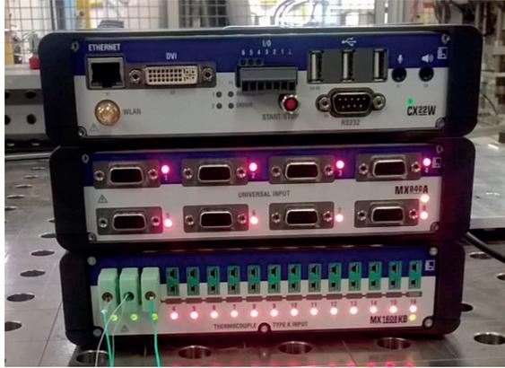
Abbildung 4.2: Messverstärker MX1609KB und Aufzeichnungsrechner CX22W der Fa. HBM.
