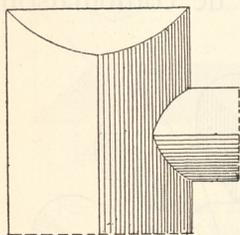
Fig. 334. — Rencontre de combles cylindriques de sections différentes. — Arêtiers et noues à double courbure.
