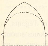
Fig. 335. — Comble cylindrique à deux égouts.
