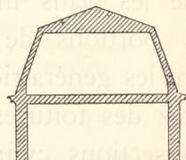
Fig. 337. — Comble brisé.
