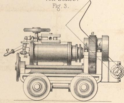
Schrämmaschine mit Schneidscheibe von Winstanley und Barker.
