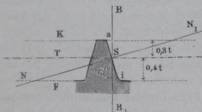
Zahnstange, Fig. 236.  $aSi$  gerade, unter  $75^\circ$  gegen den Theilkreis  $T$  geneigte Linie als Zahnprofil. Der Winkel von  $75^\circ$  ist durch Zusammenlegen der gebräuchlichen Winkelbrettchen von  $45^\circ$  und  $30^\circ$  leicht zu erhalten.
