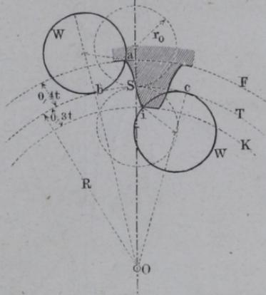
II. Verzahnung eines Hohlrades, Fig. 222. Das Hohlrad ist in den Zahnformen, abgesehen von der Rücksicht auf die Spielräume, die genaue Hohlform des gleichgrossen aussenverzahnten Rades. —  $O$  Mittelpunkt,  $R$  Theilkreishalbmesser,  $K$  Kopfkreis, um  $0,3t$  von  $T$  nach innen abstehend,  $F$  Fusskreis, um  $0,4t$  von  $T$  nach aussen abstehend.  $r_0 = 0,875t = 2,75 \frac{t}{\pi}$ ,
