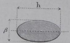
zeigt den Armquerschnitt, welcher bei Anwendung der Räderformmaschine oder der Schablonen-Sandformerei am zweckmässigsten ist; Fig. 258, ovaler Querschnitt, welcher an allen Stellen die halbe Höhe zur Breite  $\beta$  hat. Man erzielt gute Verhältnisse für die Räder, wenn man die Anzahl  $\mathfrak{A}$  der Speichen nimmt:
