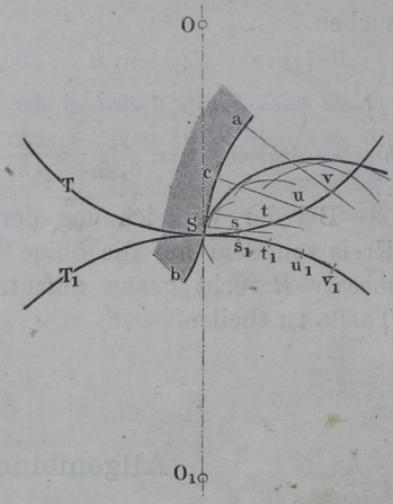
II. Abgekürztes Verfahren (Poncelet), Fig. 217. Man suche auf dem Theilkreis  $T_1$  die Punkte  $s_1, t_1, u_1, v_1 \dots$  auf, welche mit den Punkten  $s, t, u, v \dots$  des gegebenen Kreises  $T$  zusammentreffen, beschreibe aus  $s_1, t_1, u_1$  u. s. w. mit den Längen der Normalen zur gegebenen Zahncurve  $va, uc$  u. s. w. Bögen, und führe berührend an dieselben eine stetige Curve, so ist diese das
