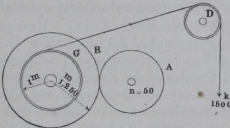
des Rades B den Seilkorb C um. Dieser habe  $1^{\text{m}}$  Halbmesser und werde durch das Förderseil mit einer Umfangskraft von  $1500^{\text{k}}$  angegriffen, schreibe aber durch seine Grösse dem Rad B einen vorläufigen Halbmesser von  $1250^{\text{mm}}$  vor; sodann soll zwischen A und B eine Uebersetzung ins Langsame wie 1:2,5 stattfinden, wonach A einen vorläufigen Halbmesser von  $\frac{1250}{2,5} = 500^{\text{mm}}$  erhält. — Hier ist für A als das kleinere Rad das Dreh-
