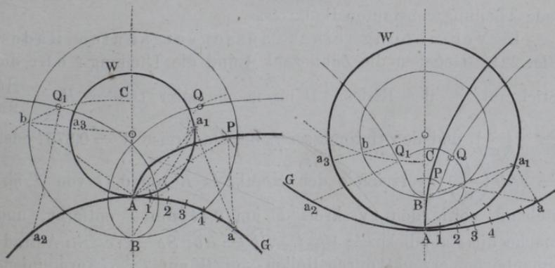
schreibe aus  $A$  mit dem Abstand  $aa_1$  einen Bogen, und aus  $a$  mit der Sehne  $Aa_1$  ebenfalls einen Bogen, so schneidet letzterer den ersteren in einem Punkte  $P$  der gesuchten Curve. Dieses Verfah-
