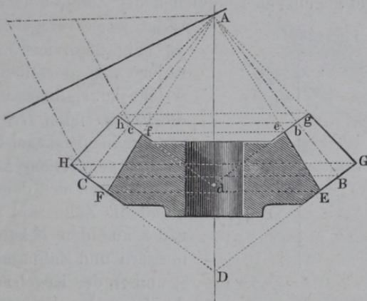
wird auf dem Ergänzungskegel des Grundkegels gemessen;  $BDC$  ist der Ergänzungskegel ( $\angle DBA = 90^\circ$ ) und es ist  $EG = FH$  die Zahnlänge; die Zahnbreite  $Bb$ ,  $Cc$  wird auf der Erzeugungslinie des Grundkegels gemessen, die Zahndicke auf dem Theilkreis; die Zähne sind Pyramiden, deren Spitzen in  $A$  liegen.
