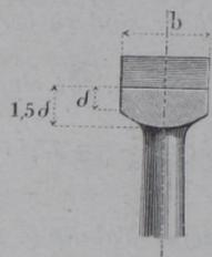
gesteift, bei kleineren Theilungen auch wohl bogenförmig profilirt, Fig. 244, wozu aber nur Arme von ovalem Querschnitt passen. Eine Theilung von 20<sup>mm</sup> erfordert nach (195) eine Kranzdicke  $\delta = 3 + 8 = 11\text{mm}$ ; bei  $t = 10\text{mm}$  wird  $\delta = 7\text{mm}$ .
