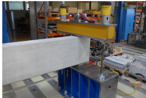
Detail Verankerung am abhebenden Ende
