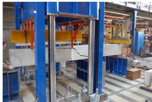
Bruchzustand - Ansicht Vorderseite gesamt
