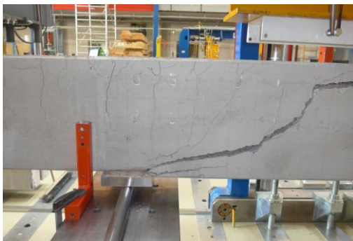
Bruchzustand - Ansicht Rückseite
