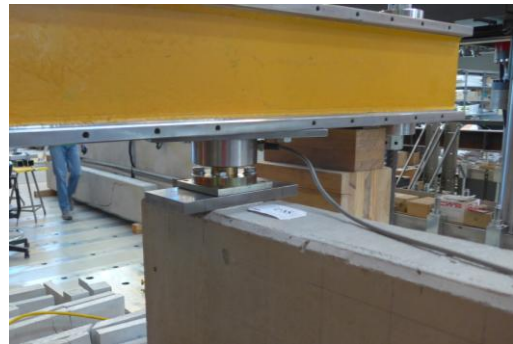
Kraftmessdose am Auflager „rechts“ - Ansicht Rückseite
