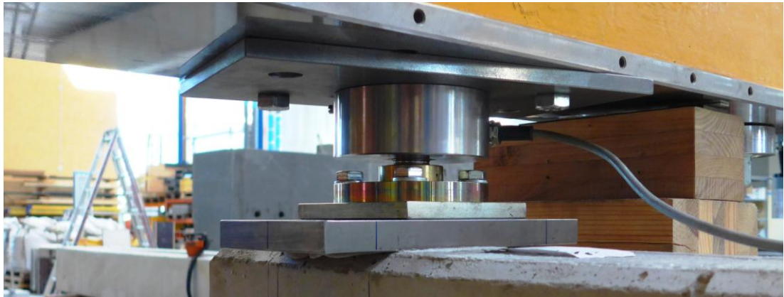
Bild 4.8 Druckkraftaufnehmer im eingebauten Zustand beim Balken SV-6
