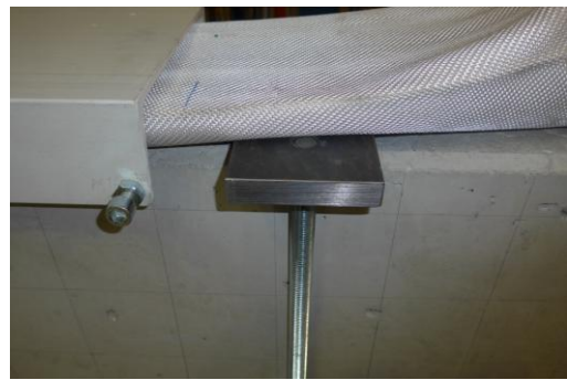
Versuchsaufbau - Detail Schubverstärkung (zu Beginn noch nicht aktiviert!)
