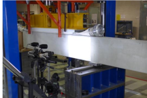
Übersicht - Vorderseite mit Messfeld für optische 3D-Verformungsanalyse
