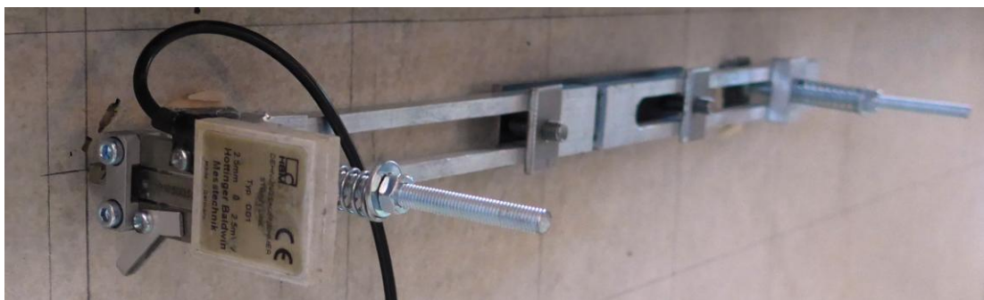
Bild 4.9 Dehnungsaufnehmer mit Messbase 380 mm
