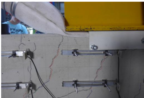
Last > 65 kN - Schrägrissbildung Rückseite Detailansicht
