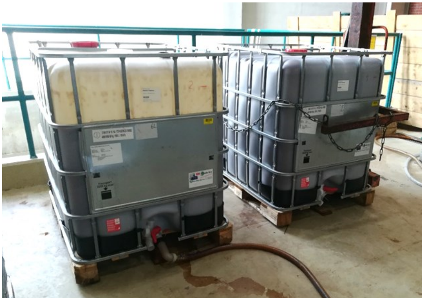
Abbildung 32: Dünnlauge in Industrial Bulk Containern
