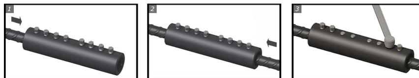
**Abb. 7.13:** Montageanleitung für mechanische Muffenverbindung mit Klemmwirkung [20]
