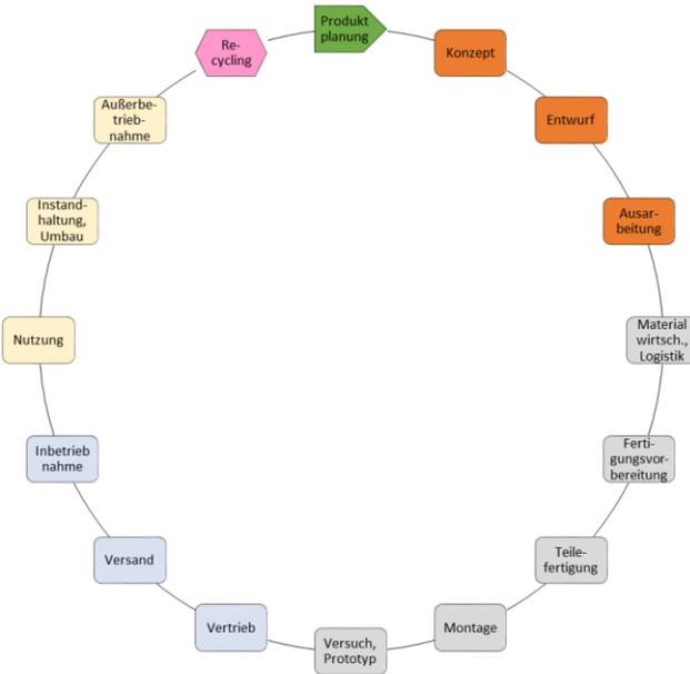
**Bild 6.100:** PEP und VDI-Methodik mit Berücksichtigung der Konstruktionsart und der zeitlichen Häufigkeit
