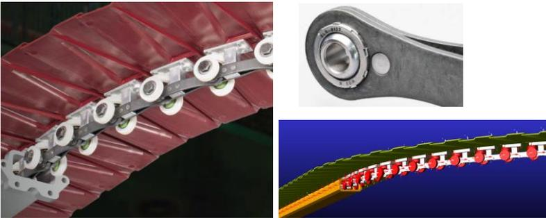
**Bild 6.56:** Plattenkettenförderer [VDI 2220] und MKS-Modell in MSC.ADAMS zur Analyse der Spurführungs- und Antriebskräfte
