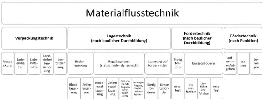
**Bild 2.15:** Systematik der Materialflusstechnik
