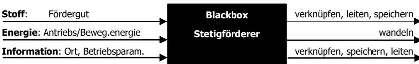
**Bild 6.107:** Stoff-, Energie-, und Informationsumsatz an einem Stetigförderer
