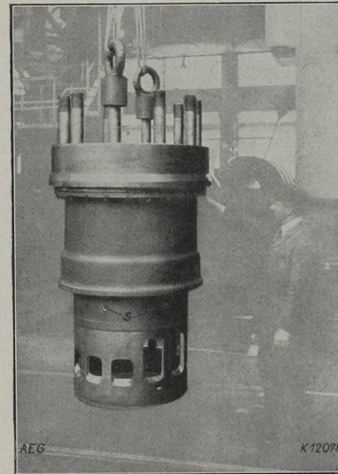
Doppeltwirkende Zweitakt-Dieselmachine, Bauart AEG-Hesselman,  $D = 680$ ,  $H = 1200$
