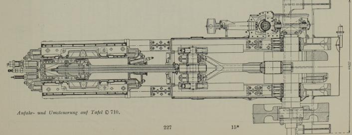
Doppeltwirkende - Zweitakt - Dieselmaschine ohne Kompressor. Bauart AEG-Hesselman. N = 6000 PS, 6 Zyl., D = 700, H = 1200. Schiffsmaschine. Ansicht von Auspuffseite.
