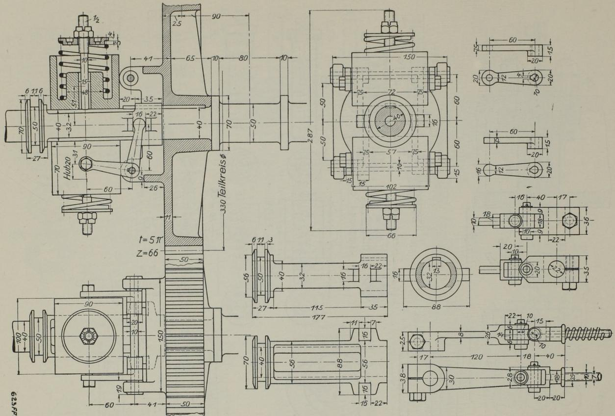
Stückliste. 1 St. Zahnrad mit Anguß für den Regler,  $t = 5$ ,  $z = 66$ , Stahlguß. — 2 St. Gewichte, Guß. — 1 St. Verschiebemuffe, Stahl. — Hebel und Gelenke, Stahl.
