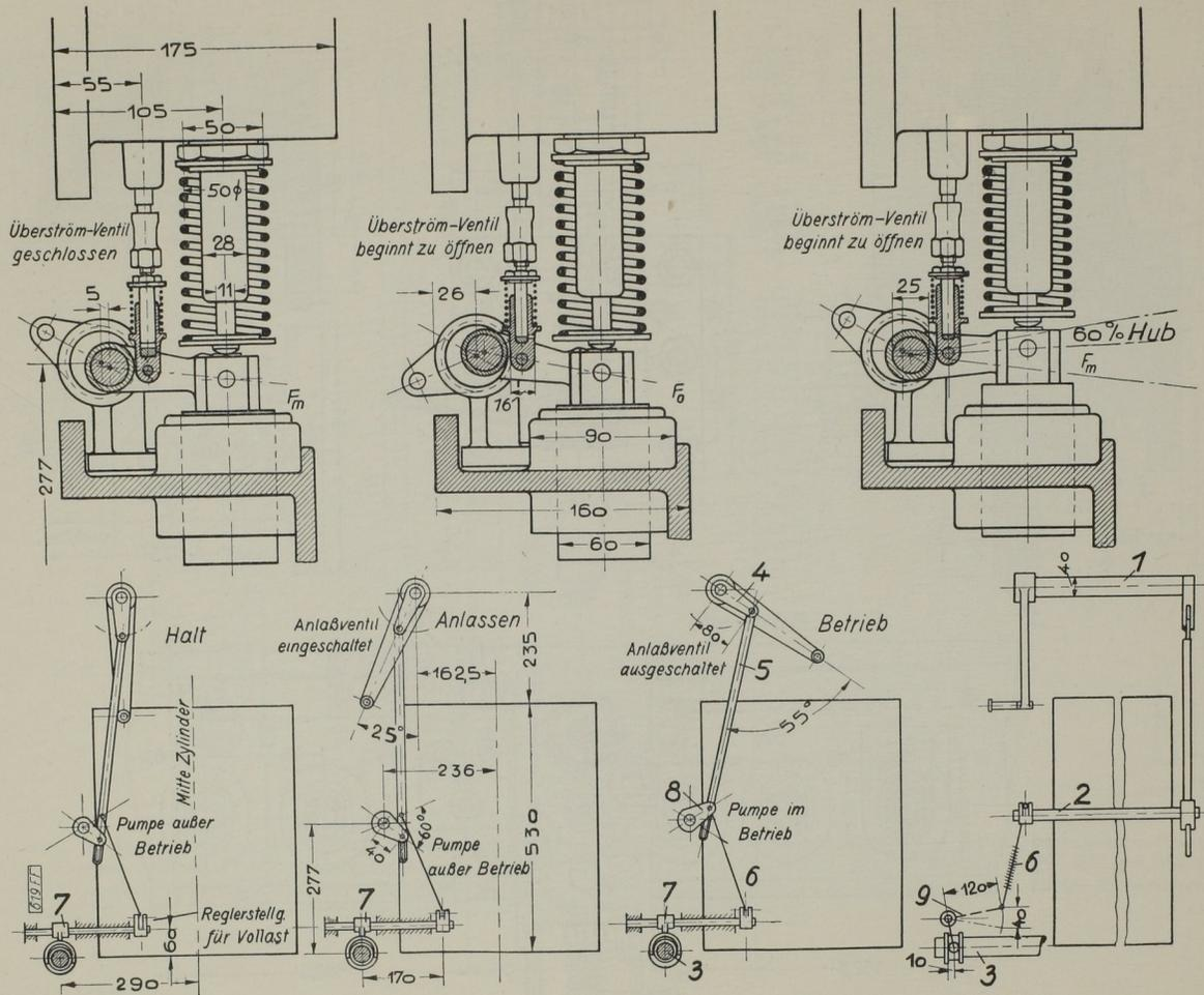
Stückliste. 1 1 St. Ventilhebelwelle, Stahl. — 2 1 St. Exzenterwelle, Stahl. — 3 1 St. Steuerwelle, Stahl. — 4 1 St. Hebel auf der Ventilhebelwelle, Temperguß. — 5 1 St. Regelungsgestänge, Stahl. — 6 1 St. Reglergestänge mit Führungshülse und Feder, Stahl. — 7 1 St. Gabel auf der Schiebemuffe des Reglers, Temperguß. — 8 1 St. Hebel auf der Exzenterwelle, Stahl. — 9 1 St. Hebel auf der Gabelachse zum Reglergestänge, Stahl.
