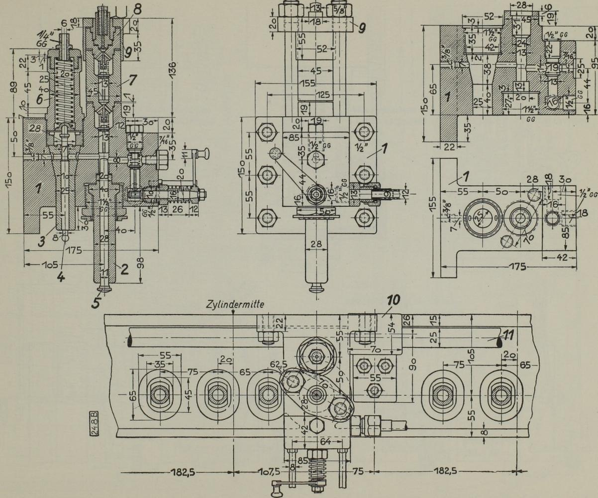
Stückliste. 1 Pumpenkörper, Stahl. — 2 Pumpenkolbenführung, Stahl. — 3 Überströmventilführung, Stahl. — 4 Überströmventil zu 3, Stahl. — 5 Pumpenkolben, Stahl. — 6 Fedenhülse für 4, Grauguß. — 7 Ventilsitz für das Druckventil, Stahl. — 8 Sitz für Rohrleitungsanschluß, Stahl. — 9 Flansch zum Aufschrauben der Ventilkörper, Stahl. — 10 Lager zu 11 Grauguß. — 11 Exzenterwelle zur Regelung der Pumpen, Stahl.
