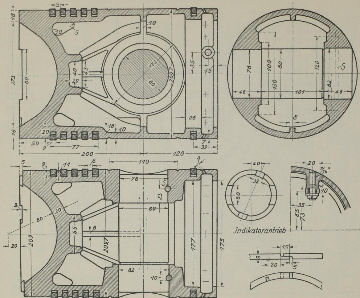
Der Kolben ist als Tauchkolben ausgeführt. Er ist stark ausgehöhlt und hat mehrere axiale Rippen zur Ableitung der Wärme an die Führungsflächen. Außer den 5 Dichtungsringen hat er noch einen Ölabstreifring. Ein Anguß nimmt den Zapfen für den Indikatorantrieb auf. Sicherungstift S ist konisch 1 : 75.
