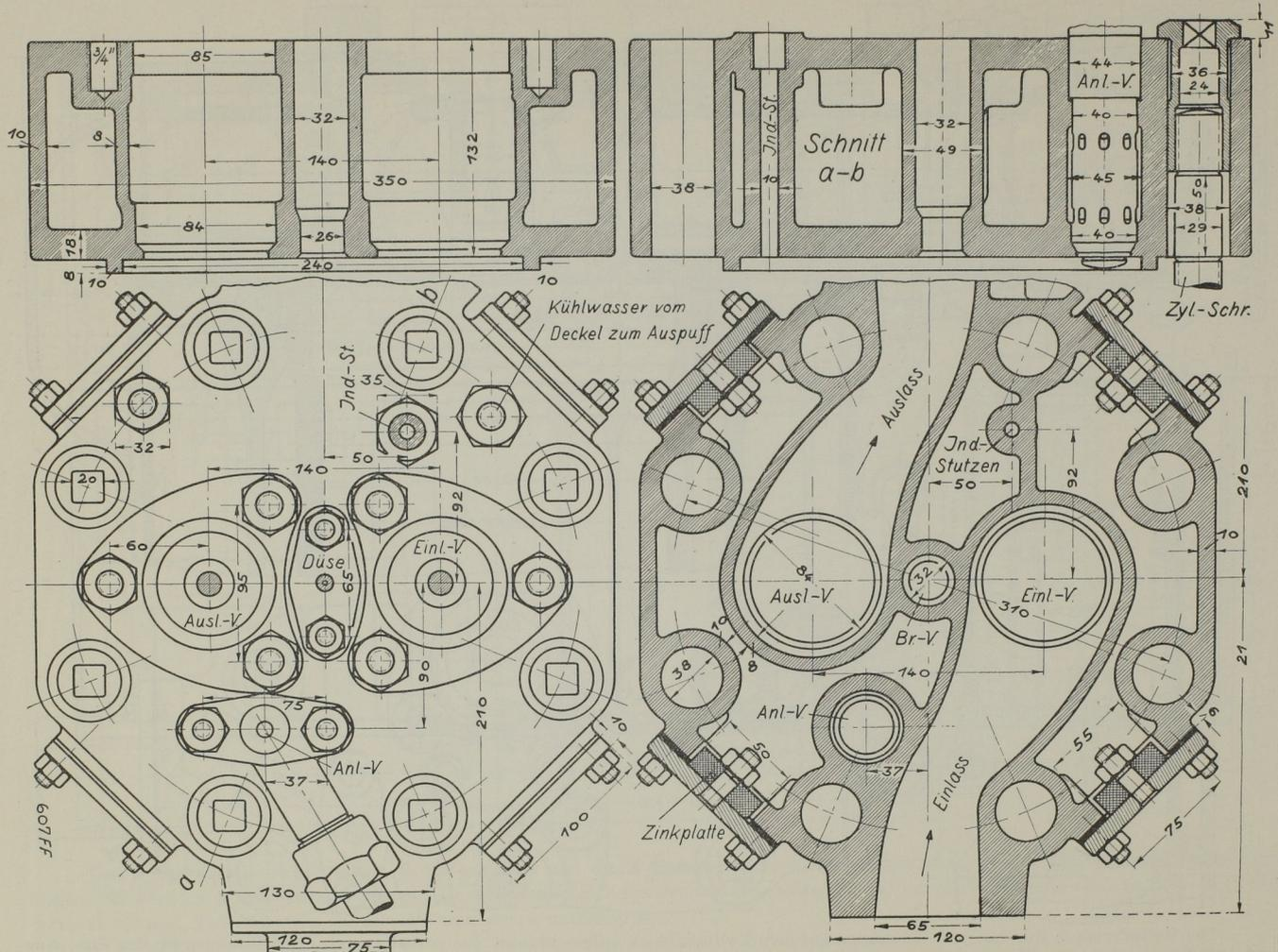
Stückliste. 3 St. Zylinderkopf, Guß. — 12 St. Deckel zu den Putzlöchern mit Zinkplatten, Guß. — 24 St. Deckelschrauben mit Hülsenmuttern, Nickelstahl.
