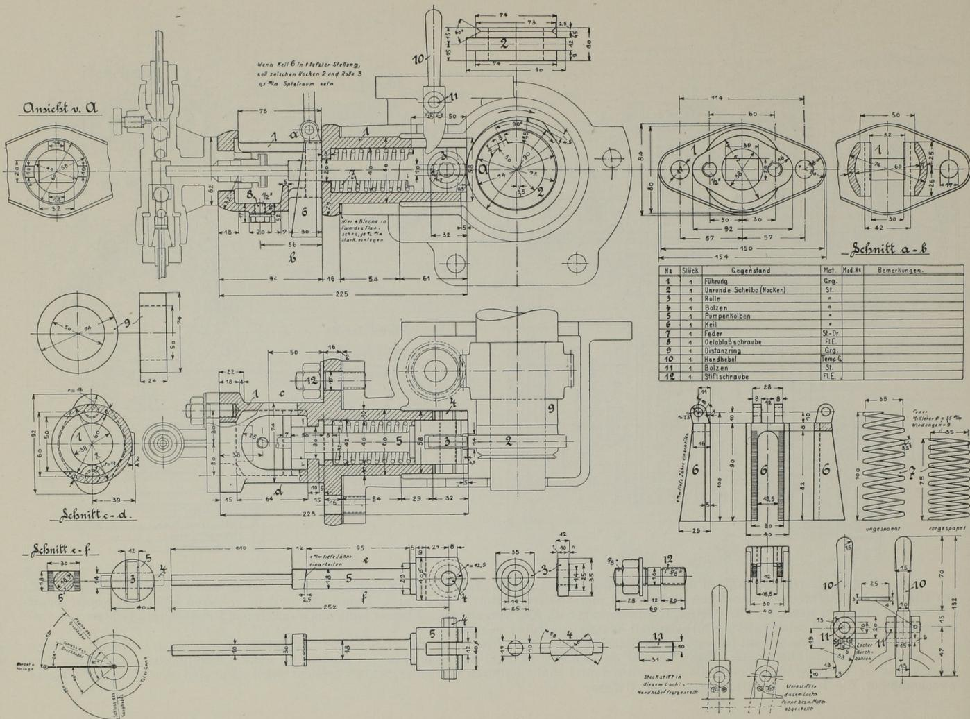
Mittels Handhebels 10 kann die Pumpe abgestellt und beim Anlassen von Hand gepumpt werden. Keil 6 wird durch Zugstange vom Regler eingestellt und verringert bei hochgehendem Regler den Pumpenhub. Vgl. 5 135 u. folg. in Band I.
