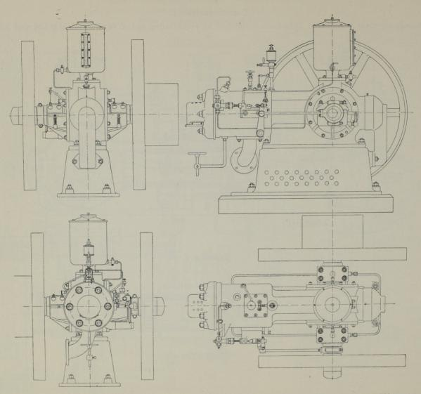
Ordnet man besonderen Zylindereinsatz an, so erscheint der Zylinderkopf verhältnismäßig groß, wie in Tafel  $\mathfrak D$  530 gezeigt.
