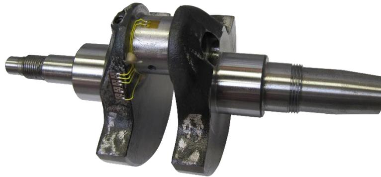
Abbildung 60: Mit DMS applizierte Kurbelwelle
