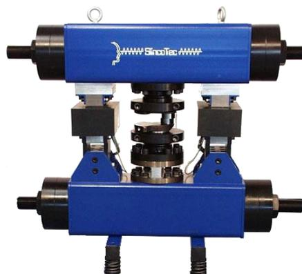
Abbildung 31: SincoTec Biege Resonanzprüfmaschine [11]
