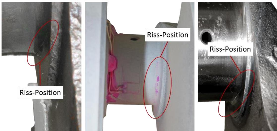
Abbildung 67: Riss Positionen bei den Versuchen mit  $\alpha=0^\circ$
