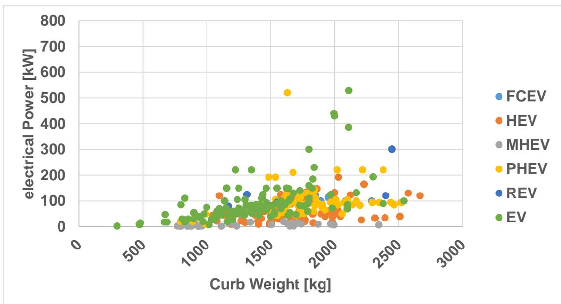
Abbildung 42: Elektrische Leistung des Elektromotors über das Leergewicht des Fahrzeuges<sup>95</sup>
