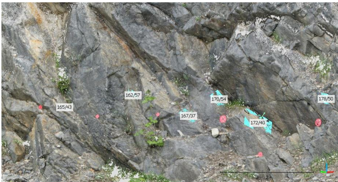
Abbildung 7.2: Orientierungen der zu Abbildung 7.1 äquivalenten Schichtflächen. Die Flächen wurden mit dem Compass Plugin eingemessen.
