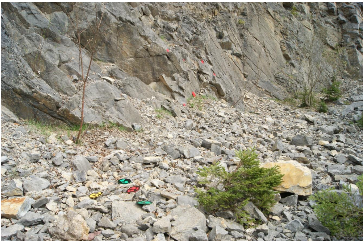
Abbildung 6.1: Bildausschnitt des westlichen Bereichs. In der linken unteren Bildhälfte sind die Referenzpunkte zu erkennen. In der Bildmitte sind die roten Punkte zu sehen, mit denen die Punktwolken im CloudCompare zusammengefügt werden können.
