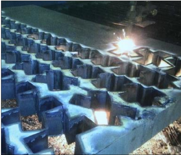
Abbildung 59: Knotenausarbeitung (Nier und Schlaich 2016)
